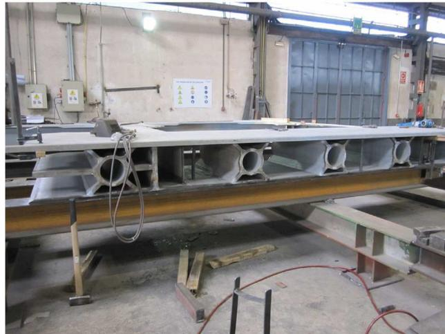
Figura 5. Análisis por elementos finitos del elemento de anclaje y fabricación del mismo.
