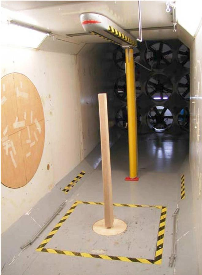
Figura 12. Ensayo de viento seccional de la pila 4.
