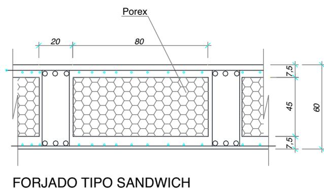
Figura 5. Sección de forjado aligerado tipo sándwich.
