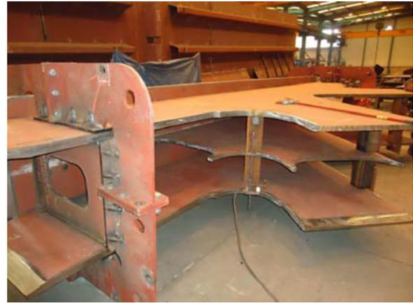
Figura 15. Vista de fabricación de un nudo tumbado.
