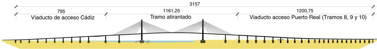
Figura 1. Alzado general del puente.
