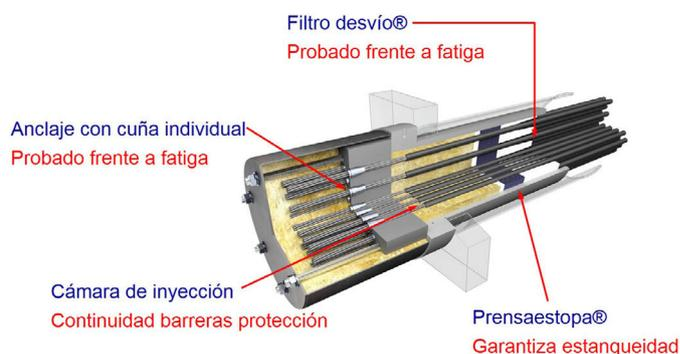
Figura 2. Anclaje Freyssinet.
