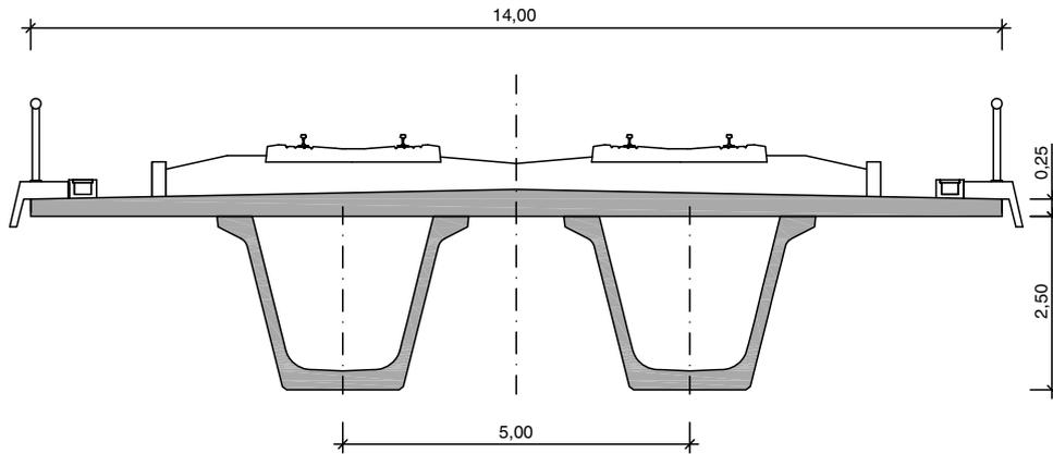
Figura 12. Sección tipo Viaducto sobre el Trasvase Tajo-Segura.
