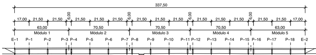
Figura 14. Alzado Viaducto sobre CV-95.
