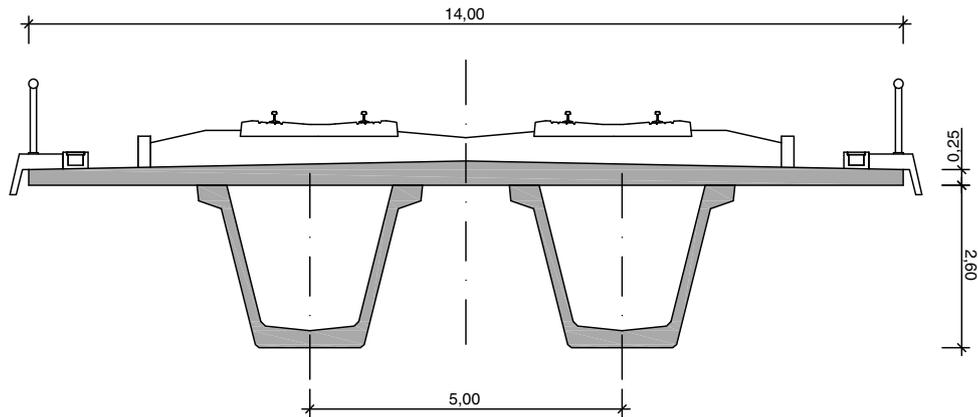
Figura 4. Sección tipo de los dos viaductos.
