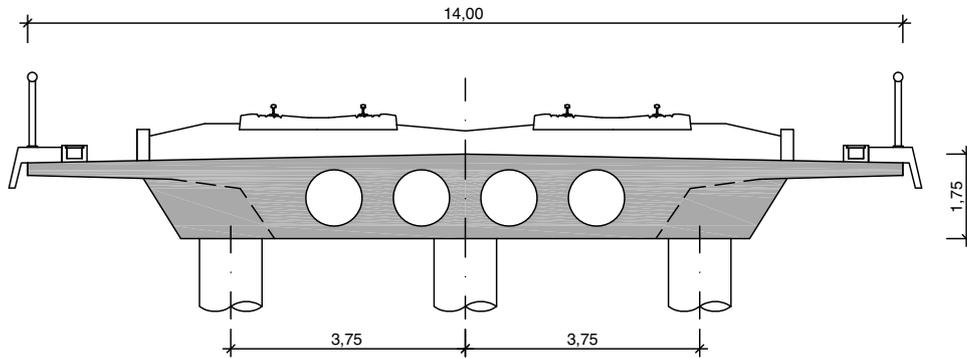
Figura 15. Sección sobre pilas Viaducto sobre CV-95.
