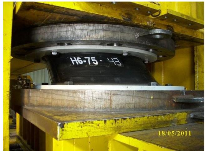
Figura 10. Ensayo dinámico sobre aislador sísmico.
