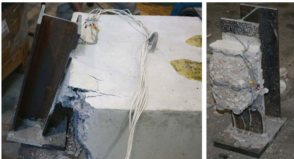
Figura 6. Rotura por fallo del hormigón.
