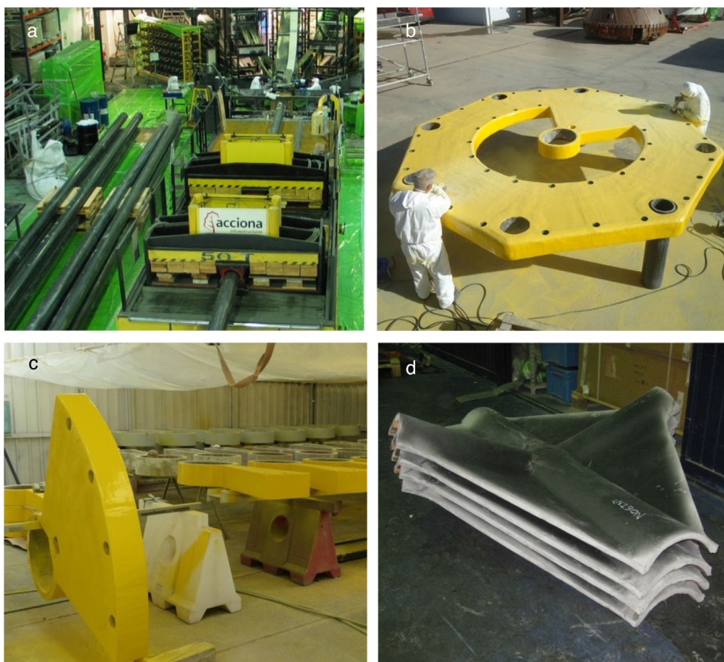
Figura 2. Elementos del faro durante su fabricación: (a) columnas; (b) forjados; (c) peldaños y descansillos; (d) diafragmas romboidales.
