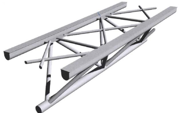
Figura 7. Celosía metálica. Esquema.
