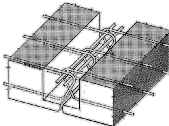
Figura 13. Esquema de unión de losas prefabricadas.
