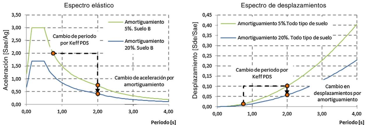
Figura 9. Efecto del amortiguamiento en la aceleración y los desplazamientos sísmicos.
