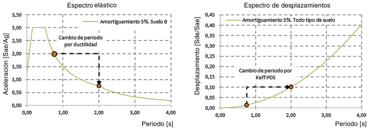
Figura 7. Efecto de la ductilidad en la aceleración y los desplazamientos sísmicos.
