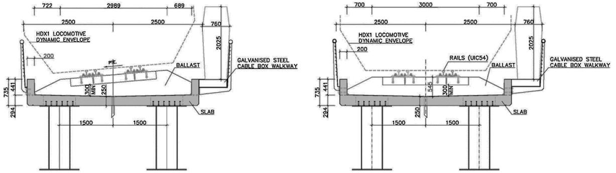
Figura 1. Secciones tipo.
