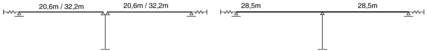
Figura 11. Esquema estructural puentes de 2 vanos.
