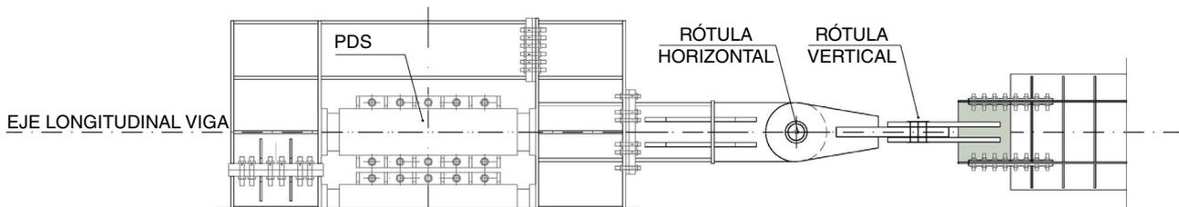
Figura 15. Pórtico metálico y rótulas de unión. Vista en planta.
