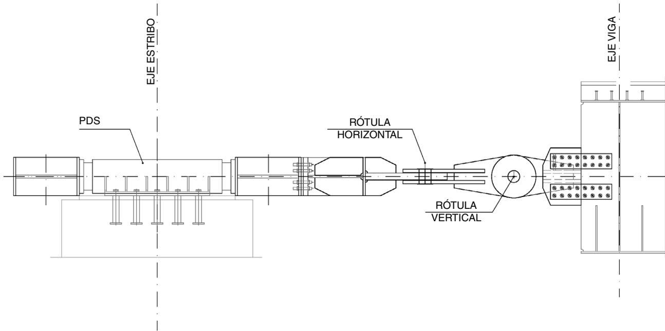
Figura 14. Pórtico metálico y rótulas de unión. Alzado.
