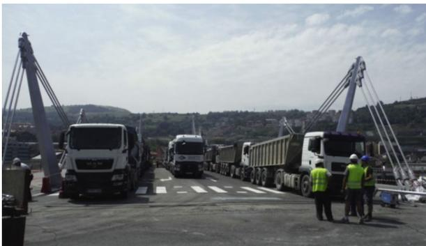
Figura 56. Prueba de carga estática.
