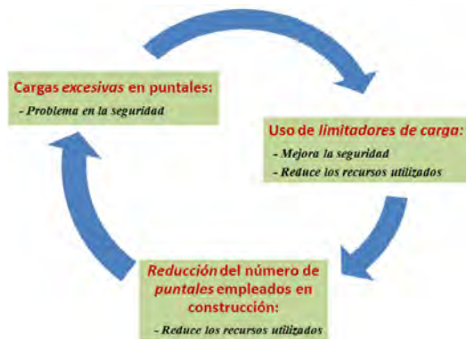
Figura 2. Principales ventajas del uso de LLs en puntales durante la construcción de edificios.
