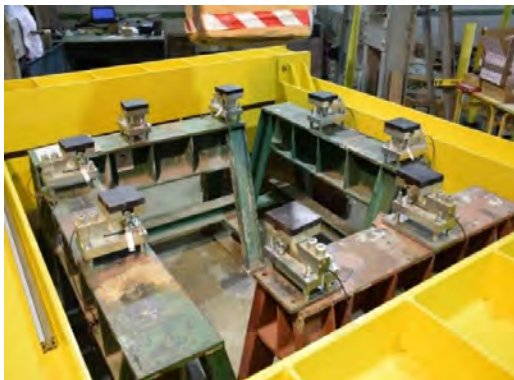
Figura 2. Sistema de apoyos sobre células de carga.
