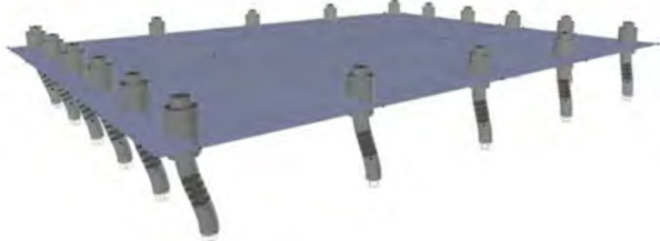
Figura 1. Deformada de los pernos de anclaje por esfuerzo cortante.
