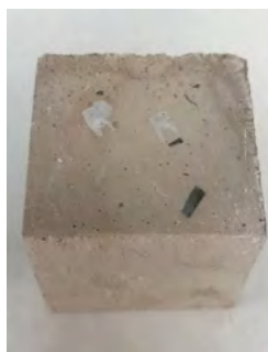
Figura 1. Probeta de Referencia (arena silicea 5 días después del ensayo).
