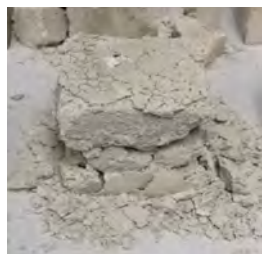
Figura 2. Probeta con sustitución de 25% de la arena silicea 5 días después del ensayo.
