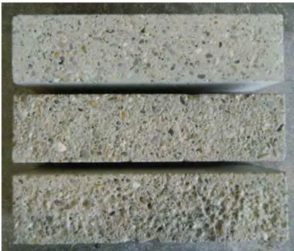
Figura 1. Rugosidad de las probetas de hormigón.
