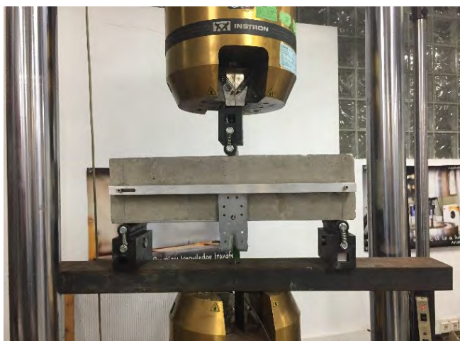
Figura 2. Colocación de la probeta en la máquina de ensayo.
