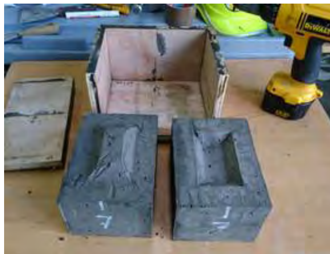
Figura 2. Fabricación de llaves de cortante conjugadas.
