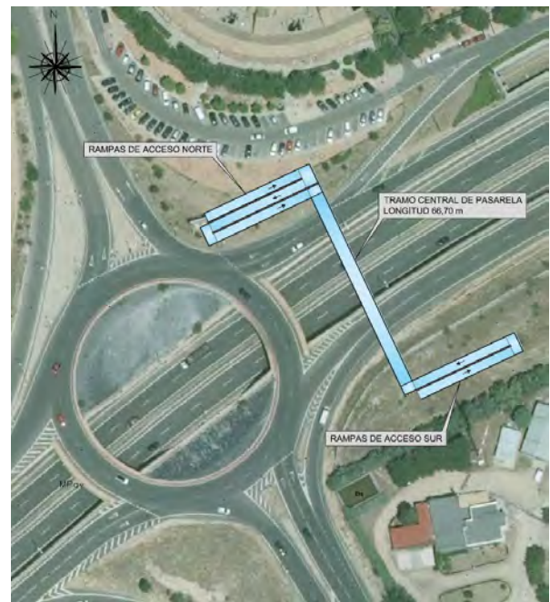
Figura 1. Planta de ubicación de la pasarela en el enlace en la M-503.
