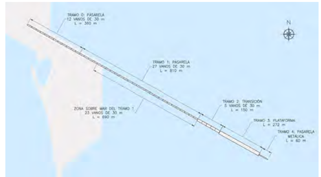
Figura 1. Tramos diferenciados en los que se divide el pantalán.
