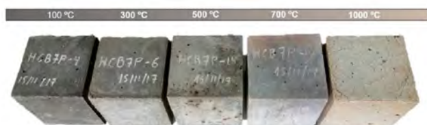
Figura 2. Aspecto visual de las probetas sometidas a altas temperaturas.
