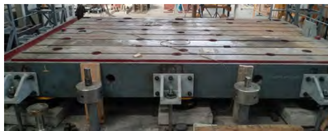
Figura 1. Mesa sísmica, junto con su utillaje principal.
