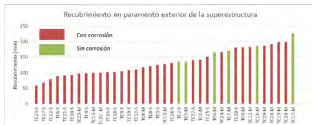
Figura 1. Recubrimiento en paramento exterior de la superestructura.
