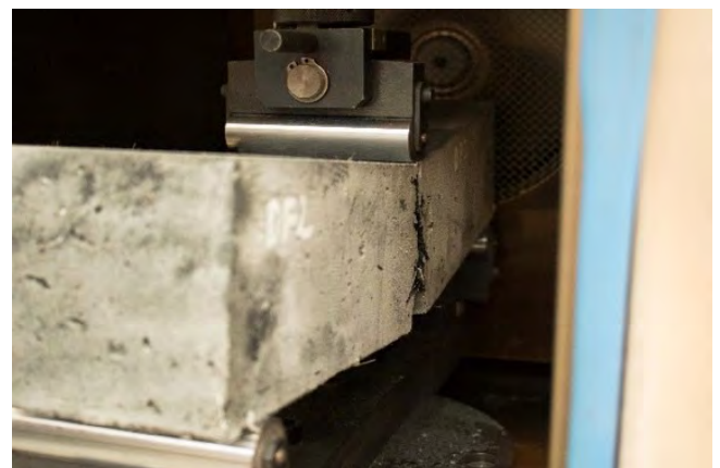
Figura 1. Ensayo a flexión en tres puntos.
