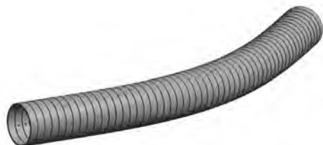
Figura 2. Geometría final del túnel, las dovelas han sido colocadas y orientadas mediante los parámetros de giro correspondientes.
