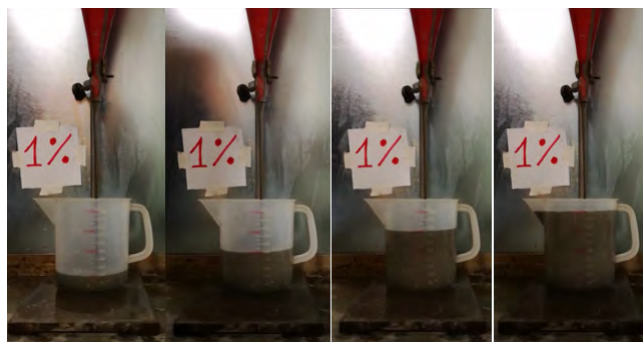
Figura 2. Toma de tiempos en el ensayo de cono de Marsh.
