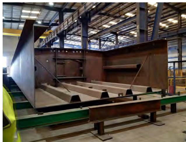
Figura 2. Sección mixta para el tramo central.
