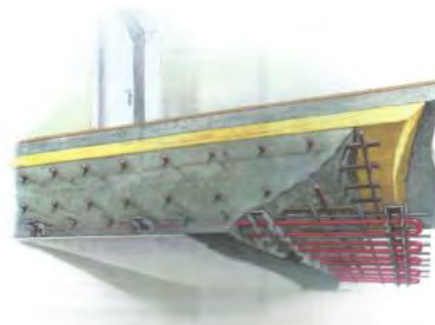
Figura 2. Configuración de forjado activado térmicamente [3].
