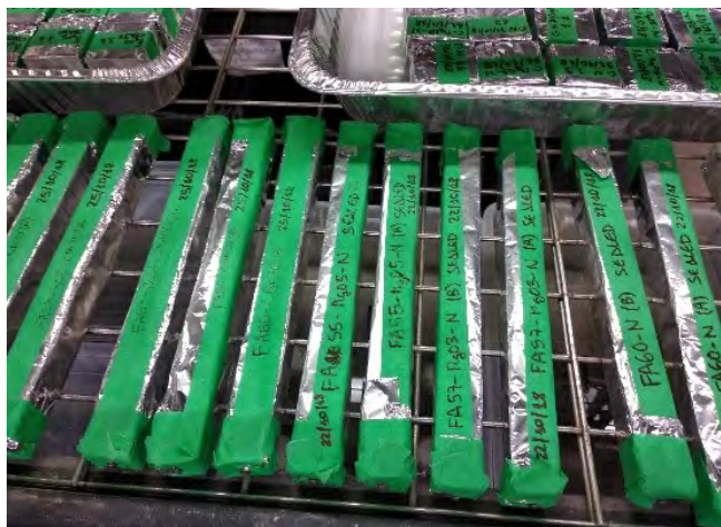
Figura 2. Probetas para medición de retracción autógena, selladas con papel de aluminio.
