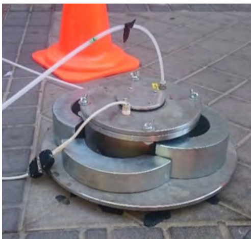
Figura 2. Medida in situ con el reactor PHOTONSITE.
