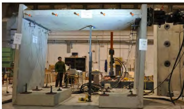
Figura 2. Vista lateral del pórtico durante la fase de tiro.
