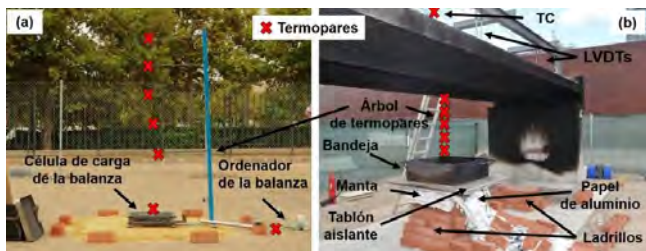
Figura 2. Elementos característicos del montaje del ensayo.
