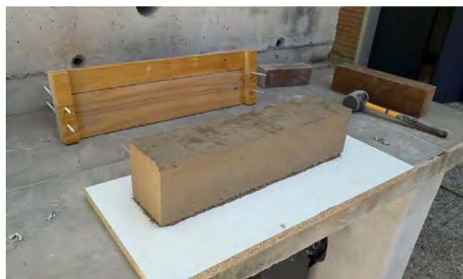
Figura 2. Probeta tapial fabricada en laboratorio.
