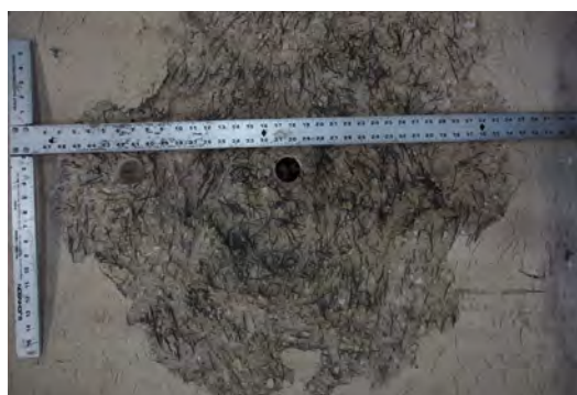
Figura 2. Dodela de hormigón reforzado con fibras de acero sometida a fuego.
