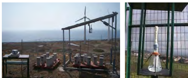
Figs. 1 y 2. probetas cilíndricas en estación de ensayo. Dispositivo de vela húmeda para la captación de cloruros del aerosol marino
