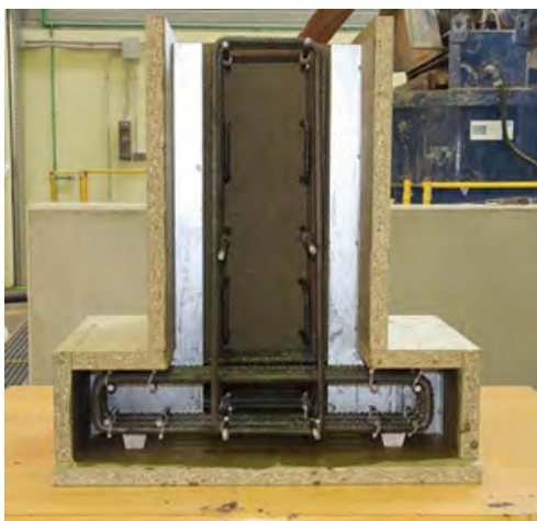
Figura 2. Probeta con armado sin tapa.
