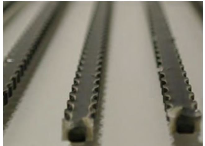
Figura 2. Barras corrugadas de fibra de basalto.
