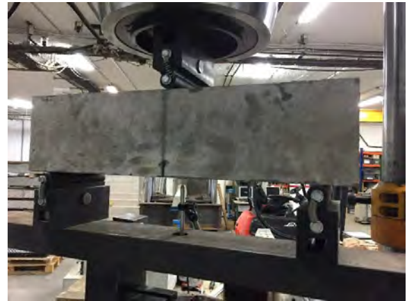
Figura 1. Ensayo de tracción por flexión.
