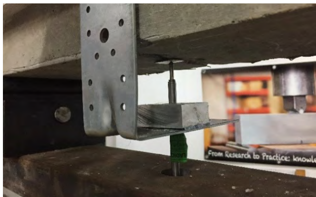
Figura 1. Detalle de la colocación del LVDT.
