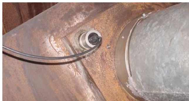
Figura 11. Sensor de detección de roturas.
