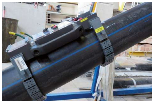
Figura 9. Sonda en tirante de prueba para calibración.
