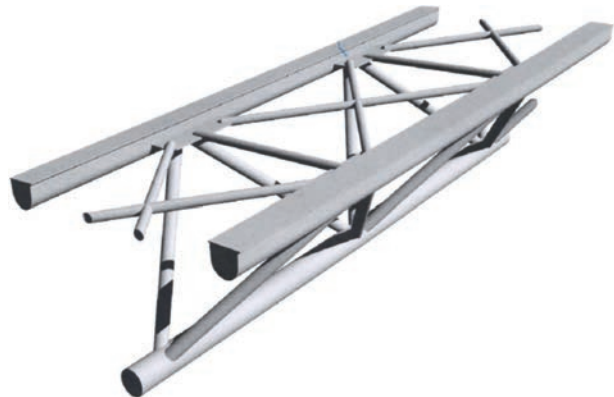
Figura 7. Celosía metálica. Esquema.
