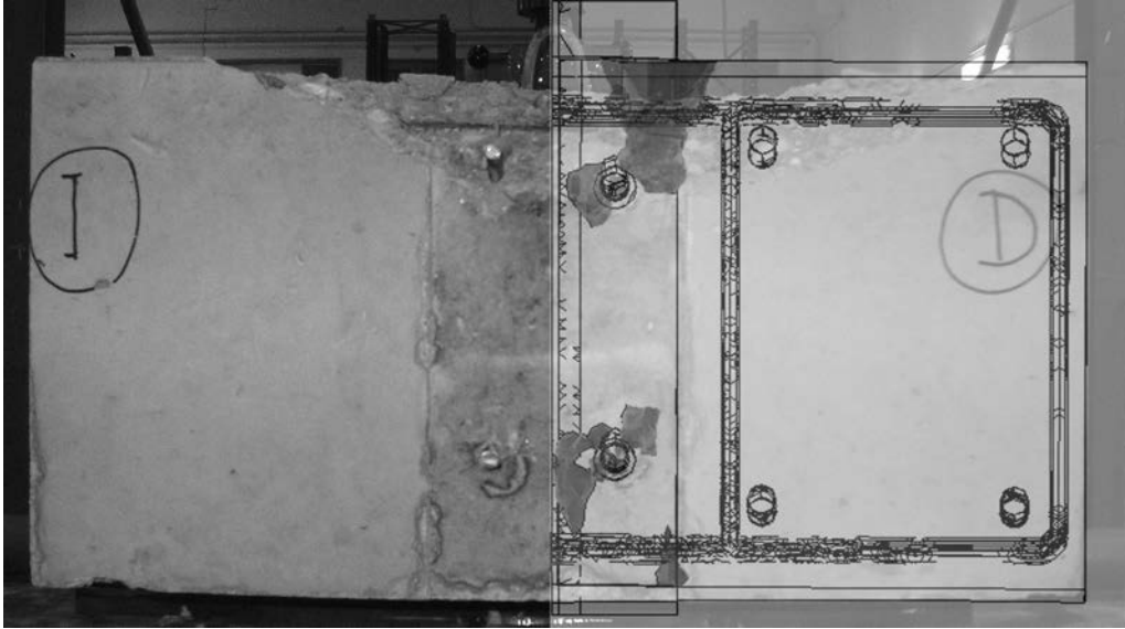
Figura 5. Comparación entre resultados experimentales y simulación por método de elementos finitos (MEF).
