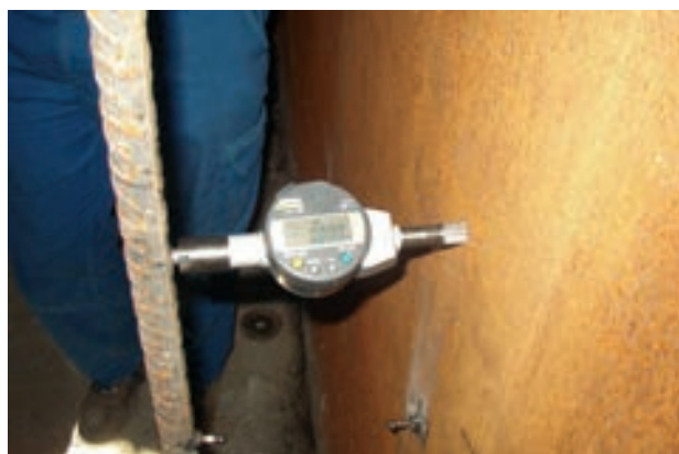
Figura 17. Control de deformaciones transversales en el alma
