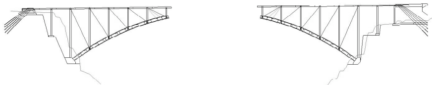
Figura 3. Proceso de construcción de avance por voladizos con diagonales temporales. Figure 3. Construction process in cantilever with temporary diagonals.
