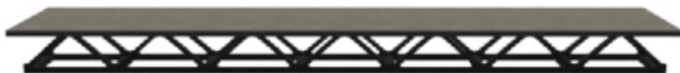
Fig. 7: Tramo de 140 m de aproximación al puente principal del Puente de Öresund. Fig. 7: Span 140 m long for the approach bridge to the main one of the Öresund Link.
