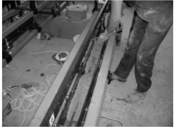
Fotografía 2. Hormigonado. Probeta integrada en el propio bastidor de ensayo.
