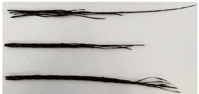
Figura 18. Muestras de los cordones rotos, en la zona de rotura (derecha) y en una zona menos dañada (foto del Laboratorio de Ciencia de Materiales).
