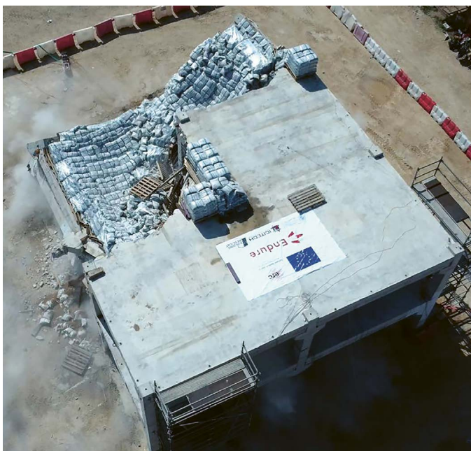
Figura 12. Foto del edificio de hormigón prefabricado construido dentro del proyecto ENDURE tras el ensayo.
