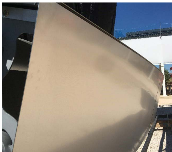
Figura 28. Fotografías de las muestras fabricadas para verificar la planimetría alcanzable por el sistema constructivo y método de fabricación digital previsto.
