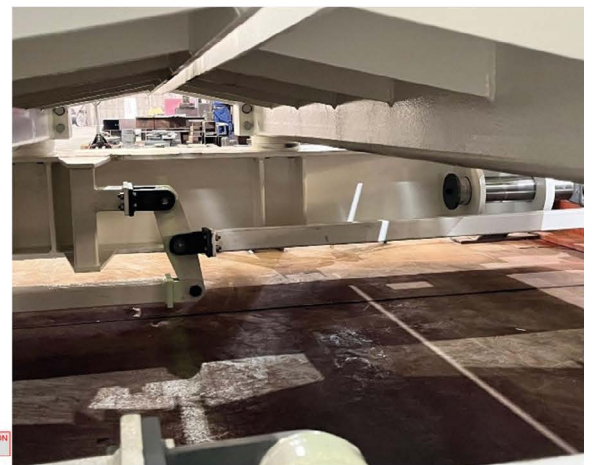
Figura 57. Sistema de centrado mecánico puentes basculantes.
