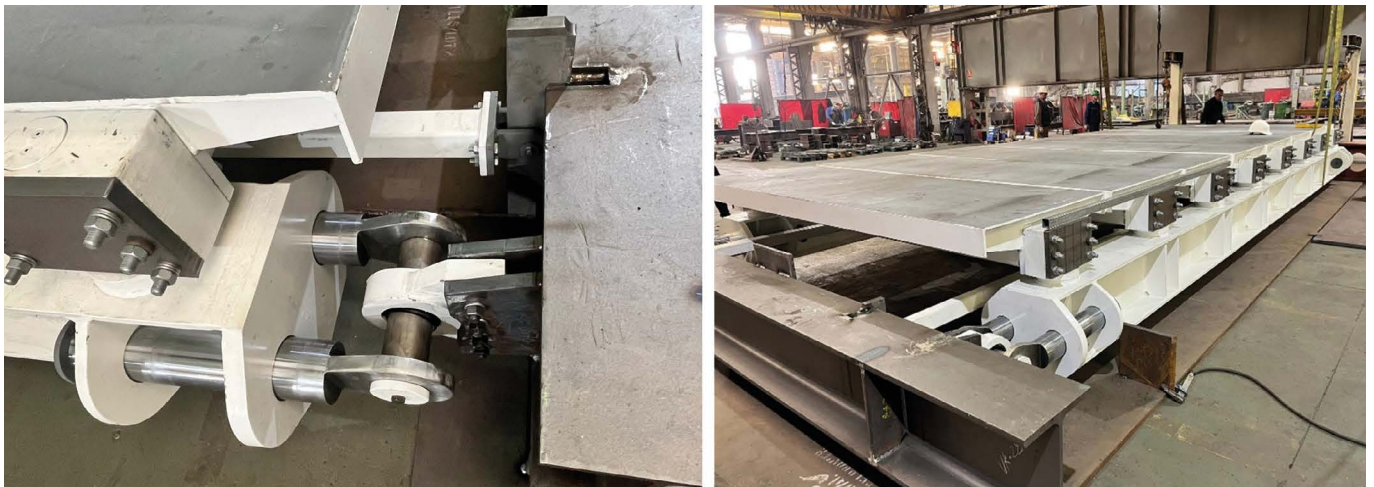
Figura 56. Prueba de funcionamiento puentes basculantes.
