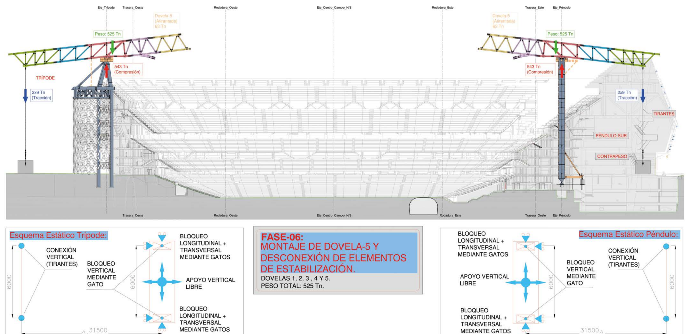
Figura 35. Esquema estático al llegar al tirante trasero.
