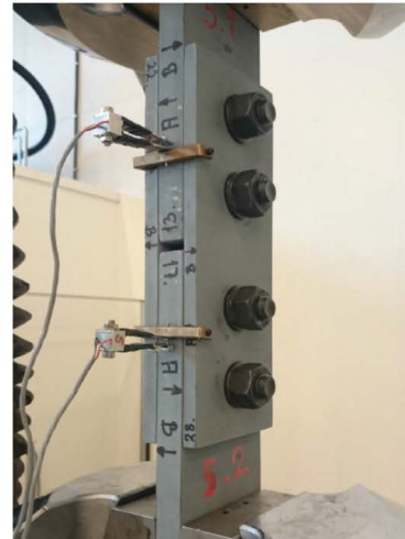
Figura 8. Ensayos coeficiente de rozamiento unión atornillada.
