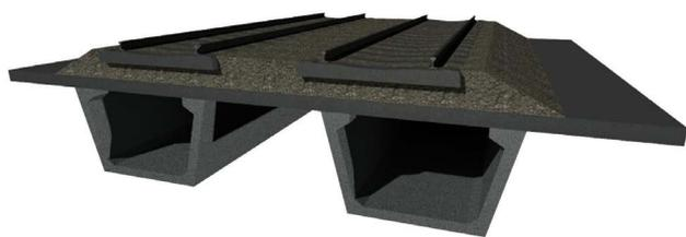
Figura 1. Configuración tipo del tablero de puente FFCC.
