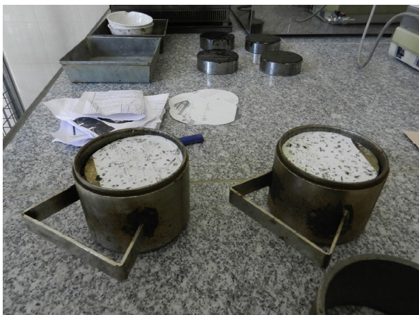
Figura 4. Probetas del firme del tramo desmontable.
