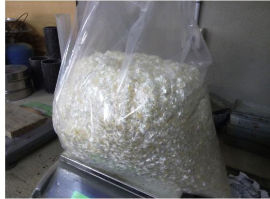
Figura 5. Fibras del firme del tramo desmontable.
