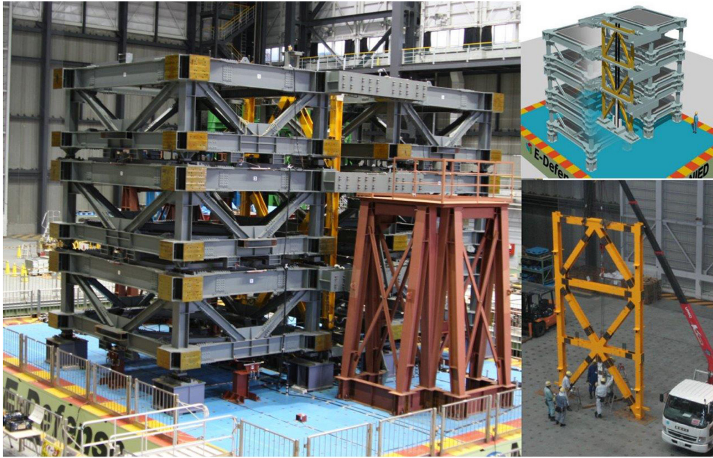
Figura 6. Ensayo en E-defensa de pórticos balanceantes y autocentrantes.
